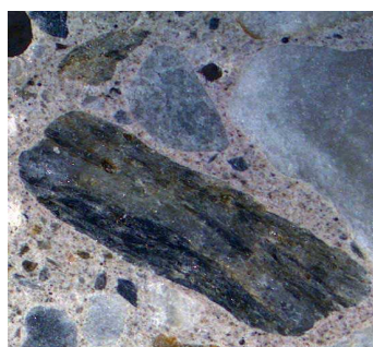
Fig. 118: Aspecto de la zona de transición pasta-árido sin signos apreciables de exudación
