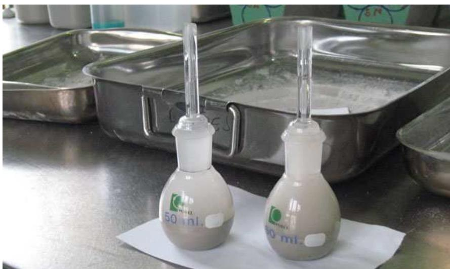
**Fig. 79:** Submuestras molidas y picnómetros con las muestras ensayadas
