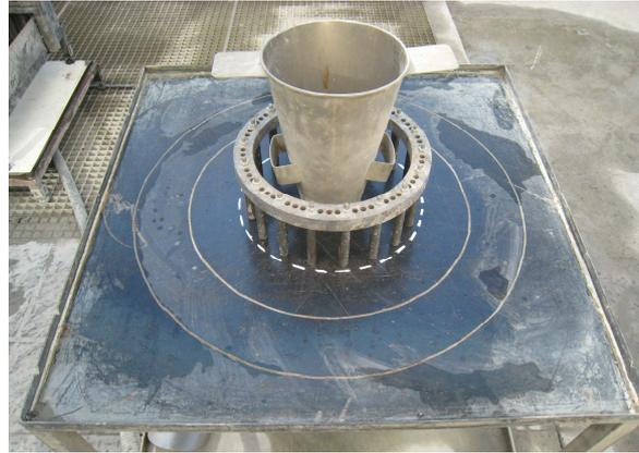
**Figura 56:** Colocación del cono y el anillo para la realización del ensayo.
