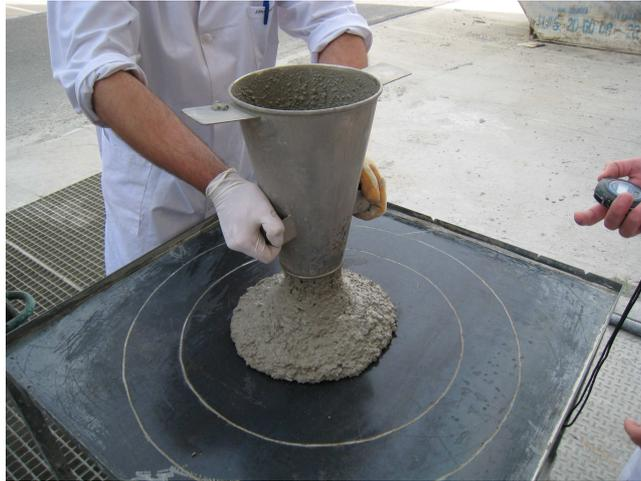
**Fig. 50:** *Ensayo de extensión de flujo*
