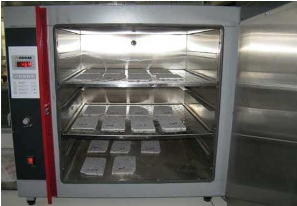
**Fig. 91:** Secado de las muestras en estufa a 60°C
