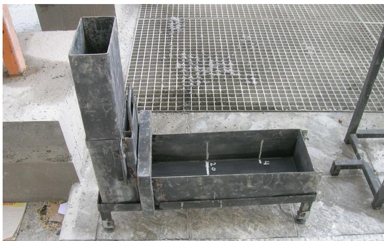
**Fig. 61:** *Caja en L utilizada para la realización de ensayos*
