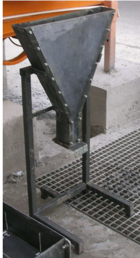
**Fig. 60:** Embudo utilizado en laboratorio para la realización de ensayos
