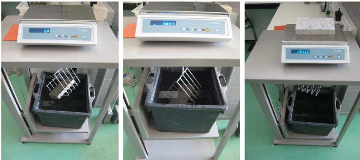
**Fig. 81:** *Proceso para obtener la masa de la probeta sumergida y saturada en agua mediante balanza hidrostática para la determinación de la densidad*
