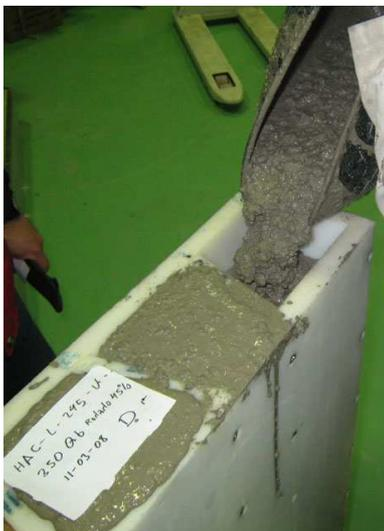
**Fig. 68:** Llenado de los moldes de hormigón autocompactante
