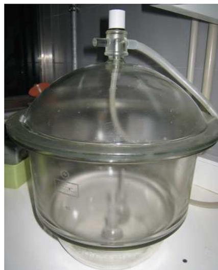
**Fig. 78:** Proceso de vacío de los picnómetro
