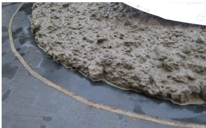
**Fig. 51:** Borde final de torta de un hormigón cohesionado.
