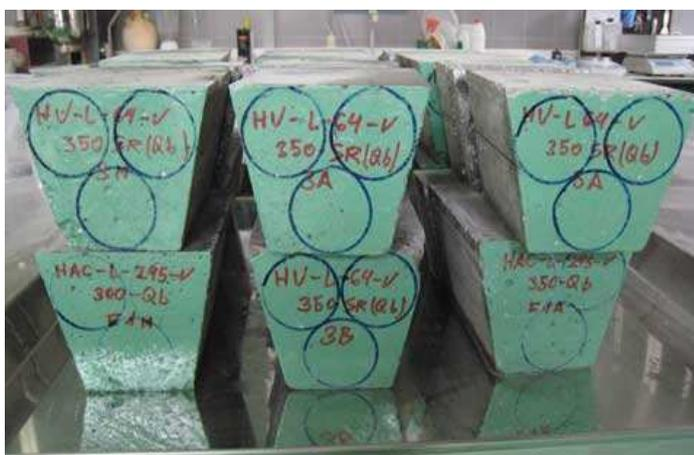
**Fig. 104:** *Señalización de los puntos donde se realizaron las medidas*
