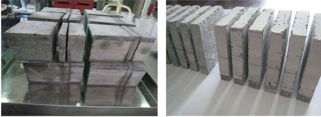
**Fig. 105:** Corte de rebanadas de las probetas tras haber estado sometidas al ataque con yeso durante 6 meses
