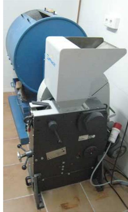
**Fig. 75:** Machacadora de mandíbulas donde se realizó la trituration inicial de la muestra
