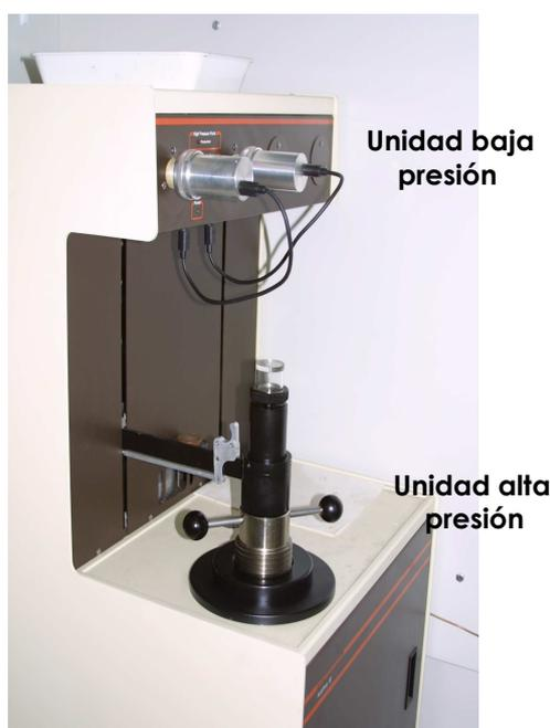
**Figura 90:** Porosímetro de mercurio utilizado en las determinaciones.
