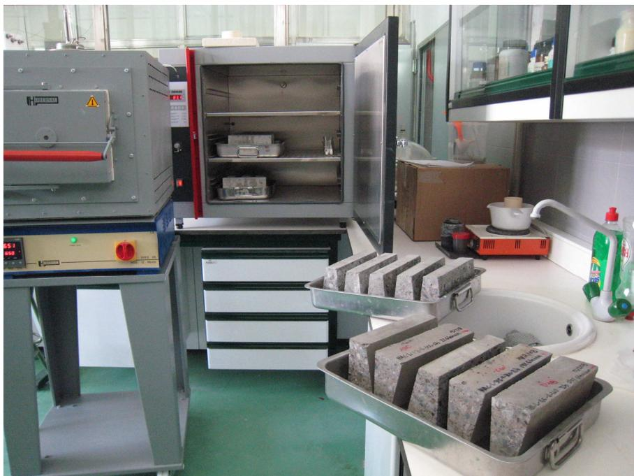
**Fig. 82:** Muestras preparadas para su secado en estufa
