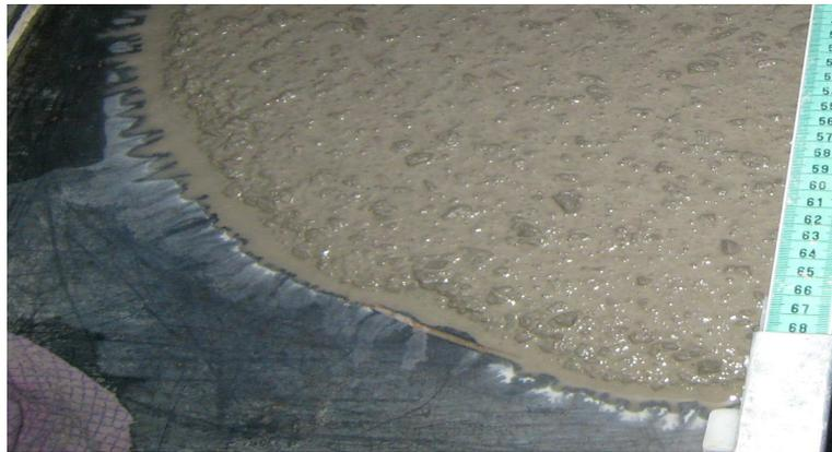
**Fig. 54:** Halo final de extendido con excesiva agua en la superficie de la mesa de ensayo.
