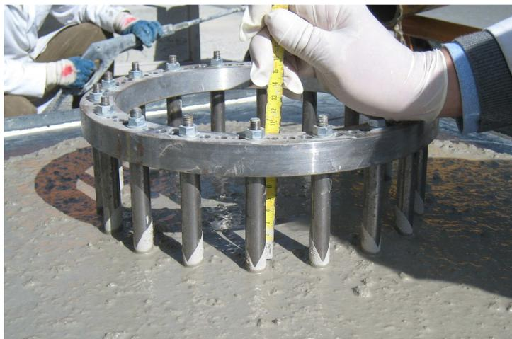
**Fig. 57:** Medida de una altura después de la relación del ensayo del anillo J
