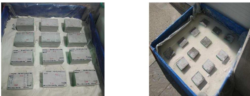
**Fig. 102:** Colocación de las muestras en el medio de ataque. Izquierda, durante los primeros seis meses. Derecha, probetas para el estudio a plazos mayores.
