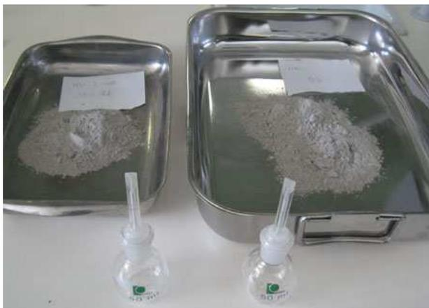
**Fig. 77:** Muestras molidas en molino de ágata y picnómetros usados
