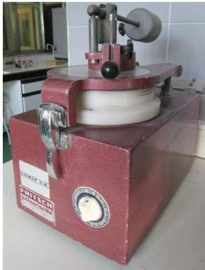
**Fig. 76:** Molturación de las muestras en un molino de ágata
