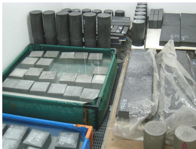
**Fig. 65:** Piscinas donde se sumergen las probetas para su curado
