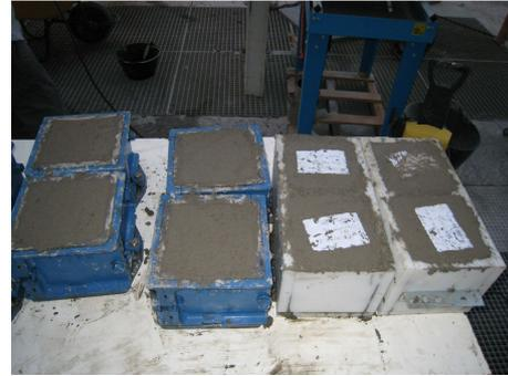
**Fig. 64:** Probetas enmoldadas e identificación del hormigón autocompactante
