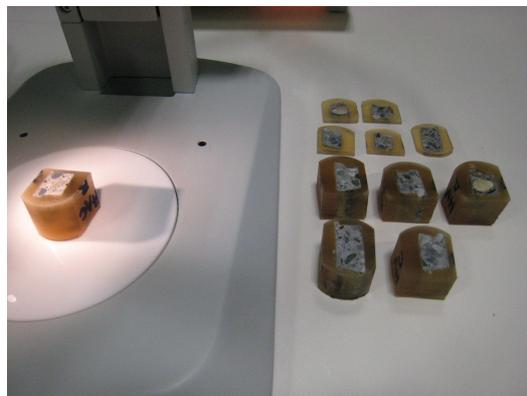
**Fig. 109:** Trozos de hormigón embutidos en resina para observar una sección de la superficie sometida al efecto de la disolución de yeso
