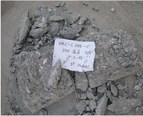
**Fig. 74:** Rotura de probeta cúbica antes de la molturación final
