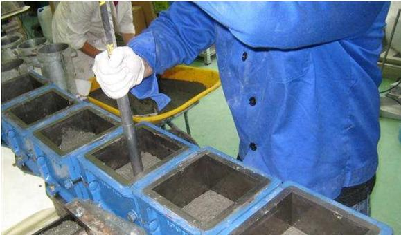
**Fig. 63:** Llenado y vibrado en dos tongadas de los moldes de hormigón convencional
