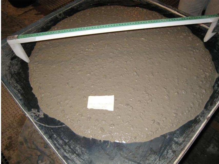
**Fig. 46:** *Aspecto de la torta en el ensayo de escurrimiento del hormigón obtenido con la dosificación G45/A45 de árido rodado.*
