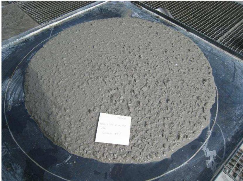
**Fig. 47:** *Aspecto de la torta en el ensayo de escurrimiento del hormigón obtenido con la dosificación G45/A45 de árido triturado*
