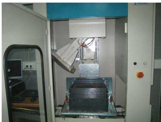
**Fig. 108:** Equipo de difracción de Rayos-X donde se realizaron los diagramas de polvo de las muestras
