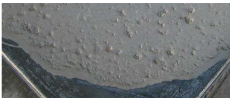
**Fig. 53:** Frente de la torta con salida del mortero con respecto a la grava
