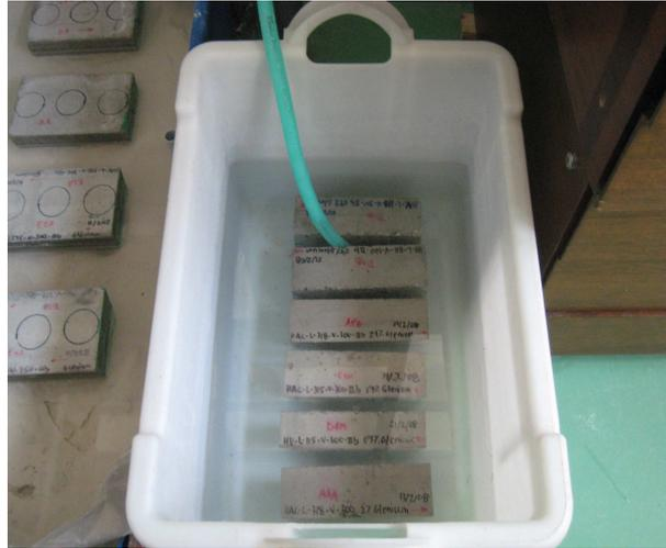
**Fig. 80:** *Probetas sumergidas en agua para su saturación*
